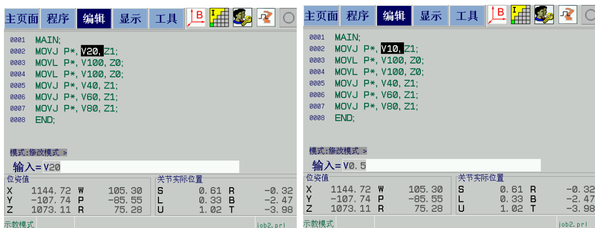
图 7-2-6-3 修改替换的内容
