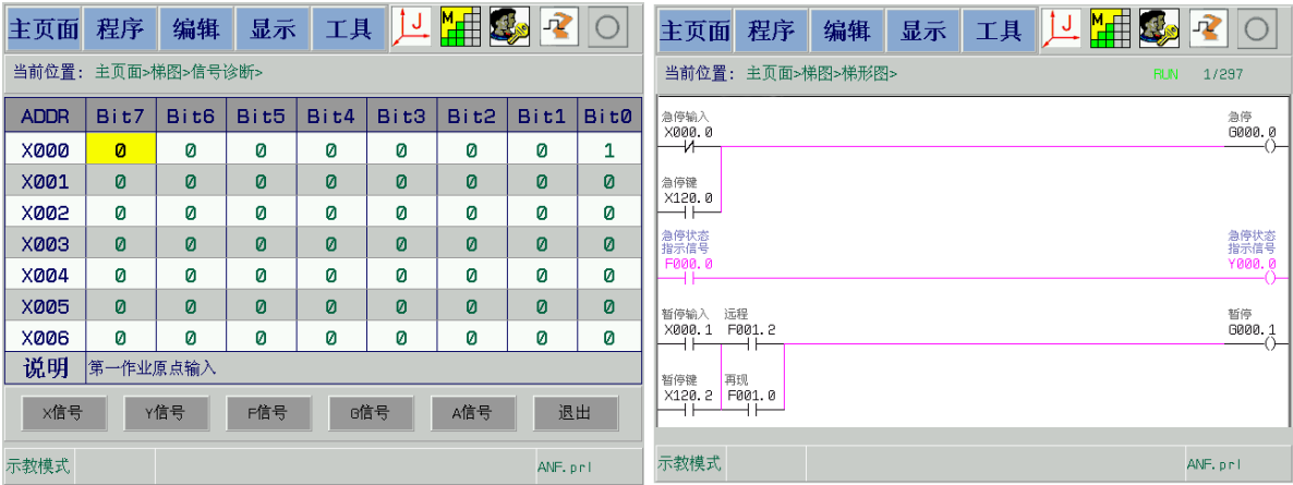
图 9-2-2-3-2 PLC 梯形图信息监控
