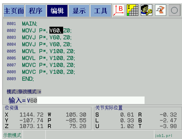
图 7-2-6-2 完成批量替换
