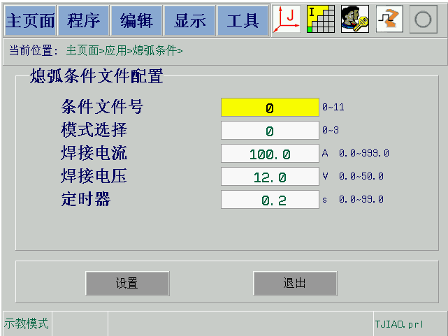
图 11-2-4-1 焊机熄焊条件配置
